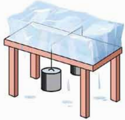
চিত্র 6.09: একটি বরফ খণ্ডকে সূত্র তাপের চাপ দিয়ে কাটা সম্ভব।
