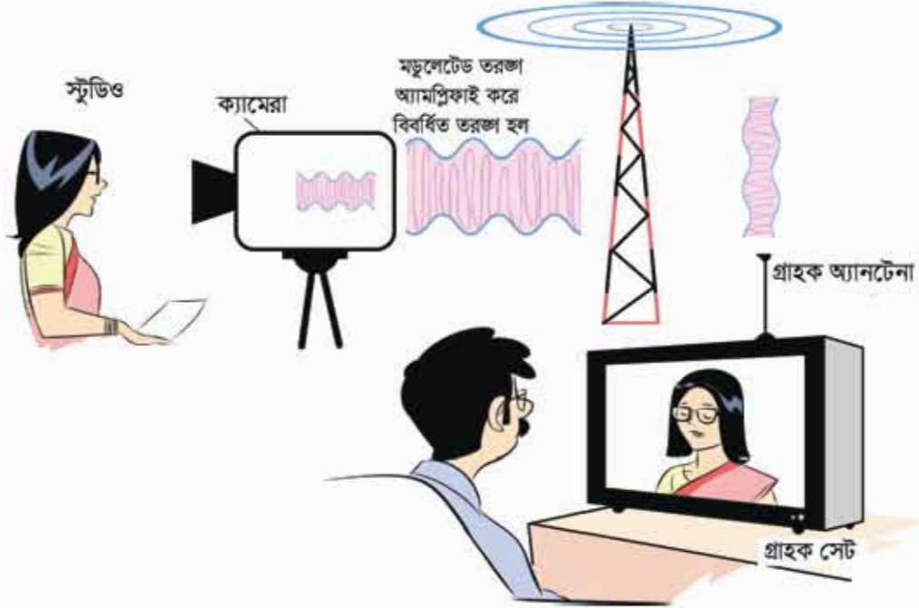
চিত্র 13.14: টেলিভিশন সম্প্রচার প্রক্রিয়া
