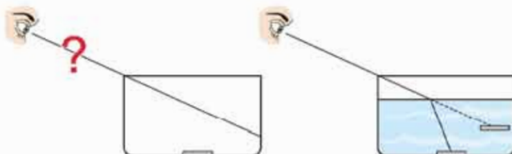
চিত্র 9.03: পানি ও কাচের তেতর আলোর প্রতিসরণ।
