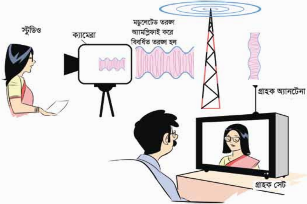
চিত্র 13.14: টেলিভিশন সম্প্রচার প্রক্রিয়া
