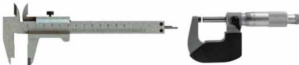
চিত্র 1.07: চিত্রটিতে ভর্নিয়ার স্কেলযুক্ত শাইড ক্যালিপার্স এবং একটি স্কুগজ দেখানো হলো।
