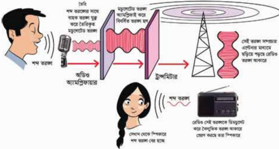
চিত্র 13.12: রেডিও সম্প্রচার প্রক্রিয়া।
