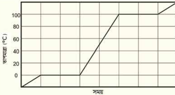
চিত্র 6.08: তাপ প্রয়োগ করার সময় গলনাঙ্ক এবং স্ফুটনাঙ্কের তাপমাত্রার পরিবর্তন হয় না।
