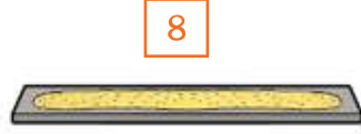
ঠান্ডা দ্রবণটি থেকে কেলাস আলাদা করার জন্যে ঢালা হয়েছে। পরবর্তী সময়ে সেটি কোনো শুষ্ক পাতের অথবা ফিল্টার পেপারের মধ্যে চাপ দিয়ে শুষ্ক করা হয়
